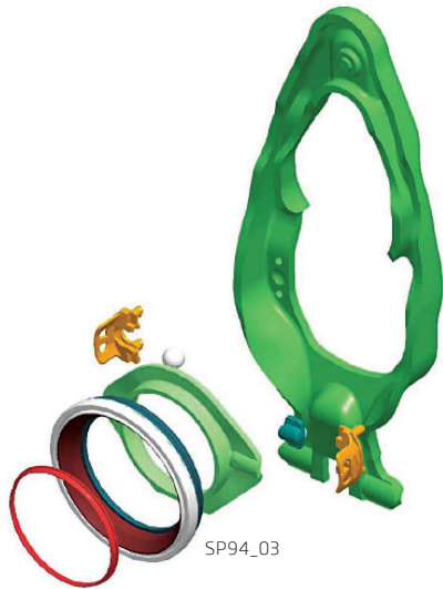
neuer Zusammenbau des Hebels bei Kupplung K1* (ab 01.06.2011)
